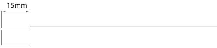
**Passaggio 2:** applicare il cavo sulla posizione di crimpatura
